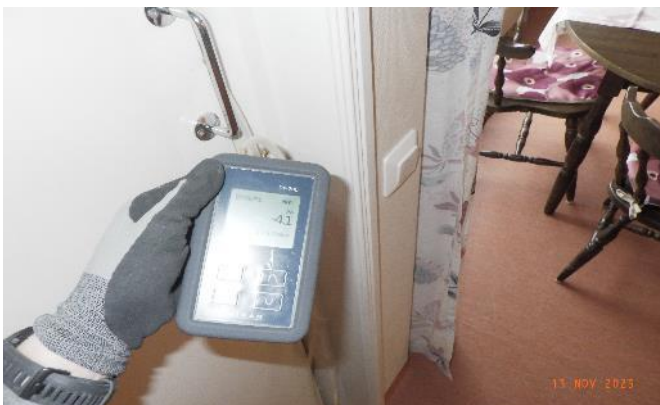
Bild 45. Tryckskillnaden uppmättes över klimatskalet.
