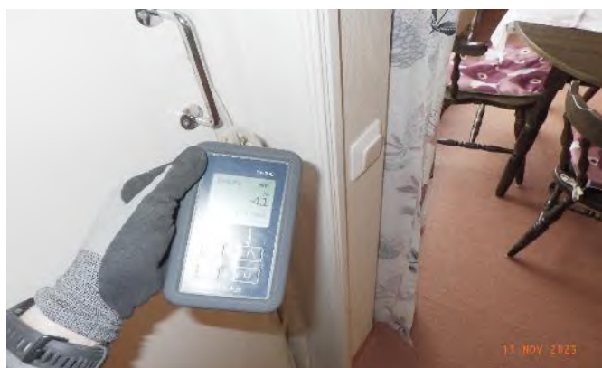
Bild 45. Tryckskillnaden uppmättes över klimatskalet.
