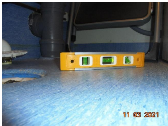
Bild 25. Plan golvyta eller mycket svag lutning konstaterades till golvbrunnen.
