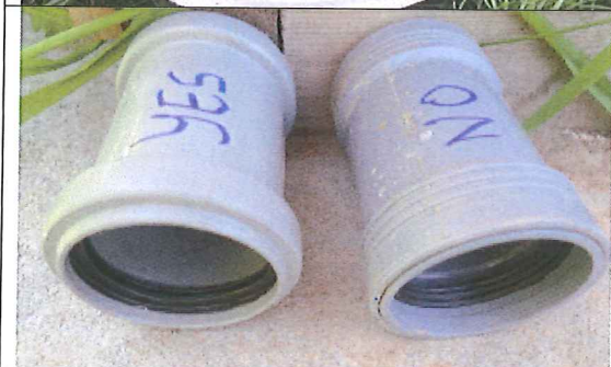
Bild 6. Olika typer av markavloppsrör. Den med plastring som klämmer till bakomliggande gummiring är olämplig att använda.
